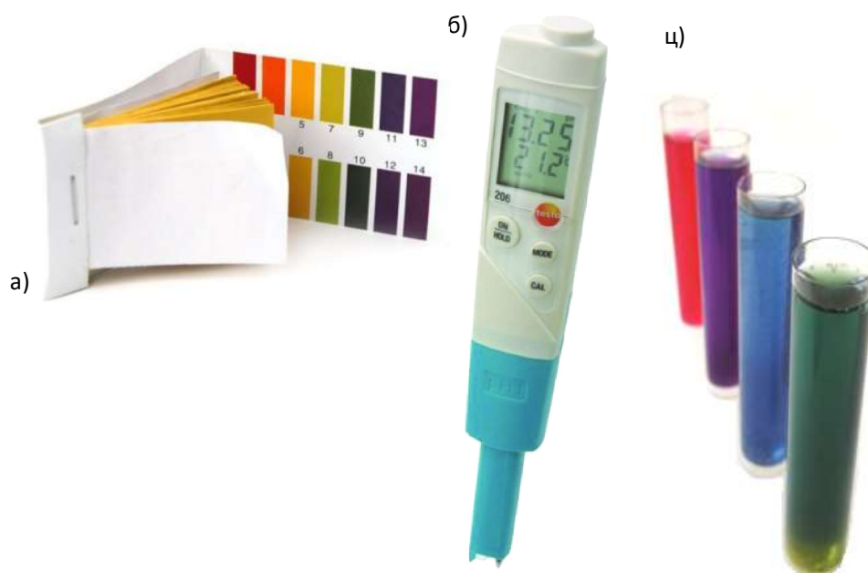
Слика 15. Методе за одређивање вредности рН: а) лакмус папир, б) рН метар и ц) индикаторске течности
