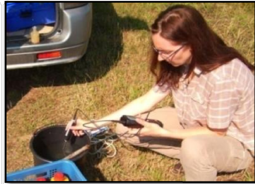
Слика 6. Мерење температуре у узорку воде
