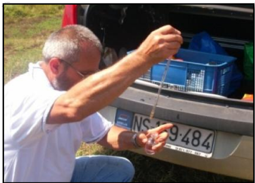
Слика 7. Фиксирање раствореног кисеоника у узорку воде
